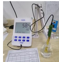
شكل (3) الجهاز المستخدم في قياس إجمالي المواد المذابة (TDS) والموصلية (EC).
