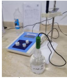
شكل (4) الجهاز المستخدم في قياس الأس الهيدروجيني (pH).
